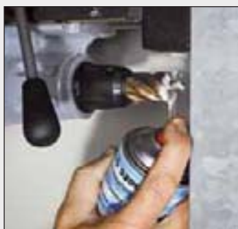
Fase 1 : prima di iniziare a forare spruzzare il lubrificante ad alte prestazioni all'interno della fresa.
