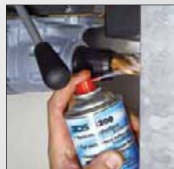
Fase 2 : durante la foratura vaporizzare il lubrificante ad alte prestazioni sulla punta della fresa e nel foro.
